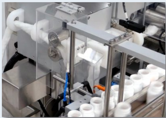
CVC 1117D 棉花塞入機配備棉花預拉系統，確保拉棉順暢與穩定速度輸出。
