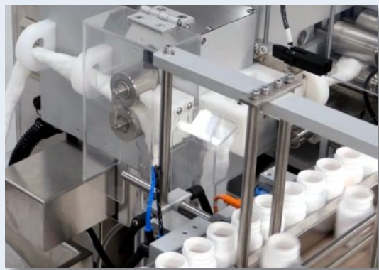
CVC 1117P 棉花塞入機配備棉花預拉系統，確保拉棉順暢與穩定速度輸出。
