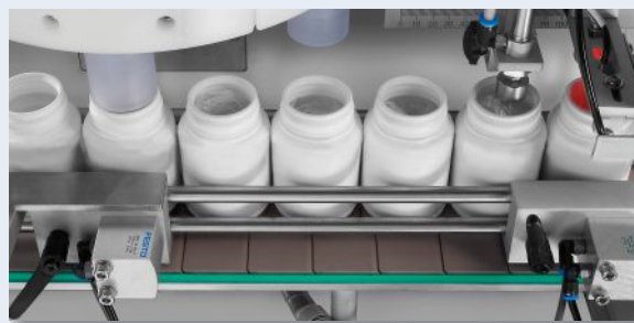
膠膜塞入瓶內後採二次下壓動作，確保膠膜塞入瓶內不彈出瓶口
