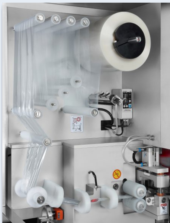
膠膜經整理繞拉後進行檢測，可精準設定與裁切膠膜長度
