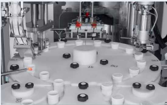
圆盘式取盖、压盖、旋盖工站
